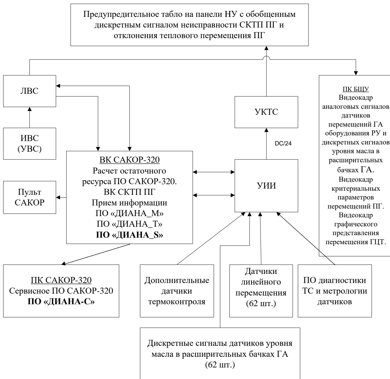
Рисунок 1 – Принципиальная схема передачи информации на ВК САКОР-320
